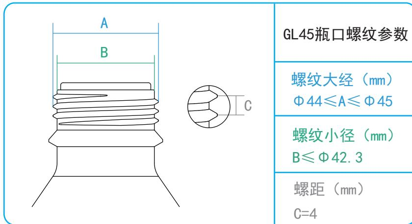
GL45是高效液相色谱溶剂瓶最常用的螺纹。在大多数情况下，使用容量为500mL或1000mL的瓶子。
